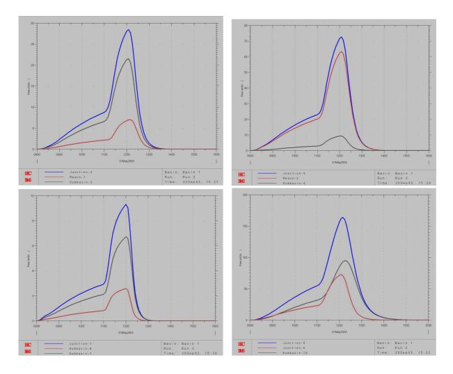
Nelle precedenti immagini sono riportati gli andamenti temporali delle portate in ingresso ed in uscita ai principali nodi (Junction) dove gli idrogrammi in uscita dai sottobacini o dai rami (reach) di propagazione vengono sommati. Nel seguito un esempio per il bacino 3 di precipitazione con perdite iniziali pari a 7 mm e di idrogramma di piena conseguentemente prodotto. (tempo di ritorno di riferimento 200 anni).
